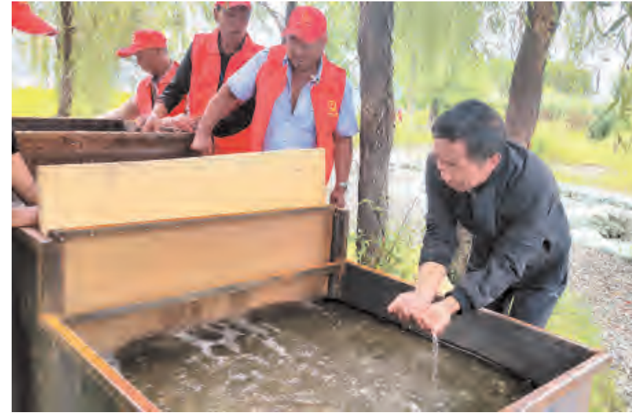
流湿地，最终实现藻水分离。投入使用后，藻水收集箱除蓝藻效果明显。
